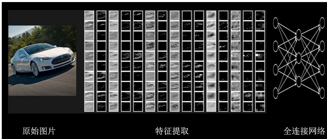
例：先将此图进行多次特征提取，再把提取后的计算机可读特征喂给全连接网络。
