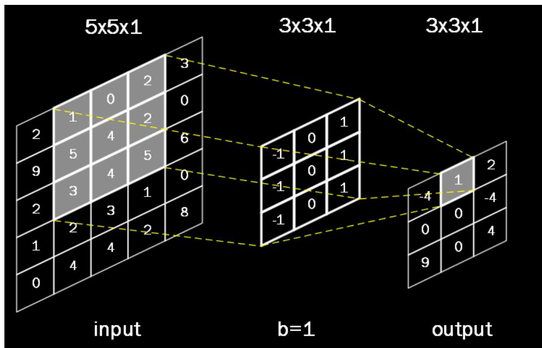
例：上面是  $5 \times 5 \times 1$  的灰度图片，1 表示单通道， $5 \times 5$  表示分辨率，共有 5 行 5 列个灰度值。若用一个  $3 \times 3 \times 1$  的卷积核对此  $5 \times 5 \times 1$  的灰度图片进行卷积，偏置项
