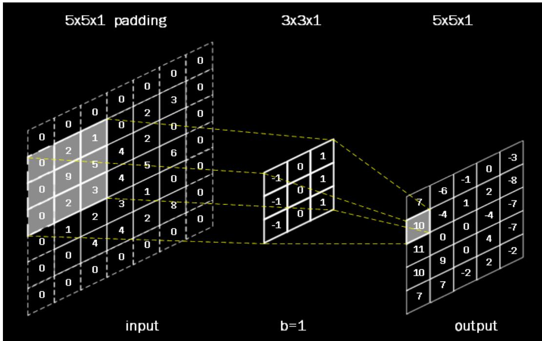
例: 在前面  $5 \times 5 \times 1$  的图片周围进行全零填充, 可使输出图片仍保持  $5 \times 5 \times 1$  的维度。这个全零填充的过程叫做 padding。
